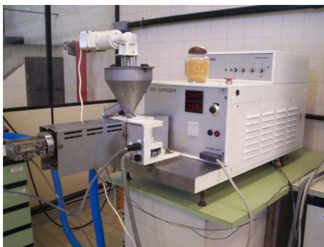
Figura 8. Extrusor Brabender mono-rosca utilizado para a produção das massas pré-cozidas
