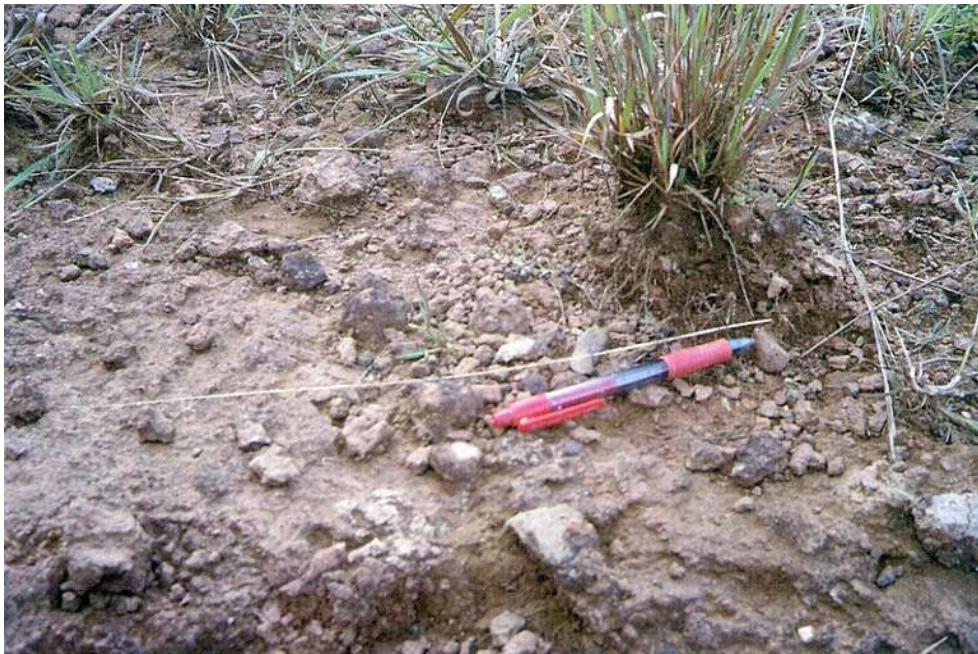
Figura 47. Colúvio superficial na porção interna do maciço. Localização: Próximo ao ponto 48 no Anexo 1.
