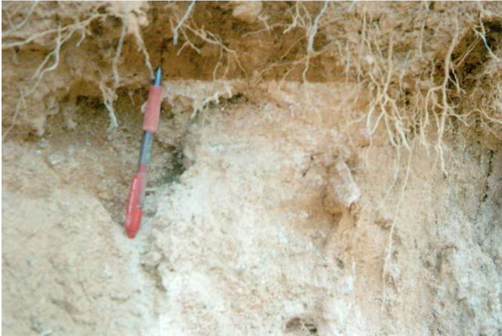
Figura 56: Contato abrupto entre volumes de alteração intempérica. Localização: Próximo ao ponto 23 Anexo 1.
