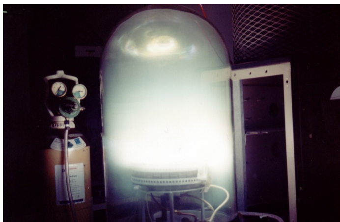
Figura 2.2: PHALL-01 (em funcionamento) na antiga câmara de vácuo “ Glass Bell Jar ”.
