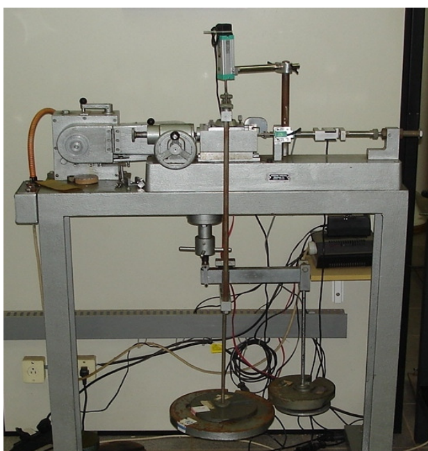
Figura 3.8 – Equipamento para o ensaio de cisalhamento direto instrumentado
