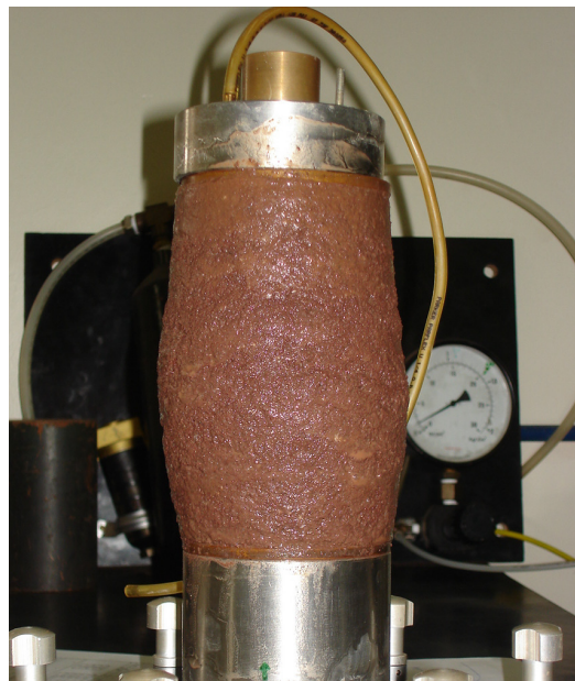
Figura 4.36 – Aspecto final do corpo-de-prova de Silveira Martins após ensaio de deformação permanente ( \gamma_{dmax} e w_{ot}+2\% )
