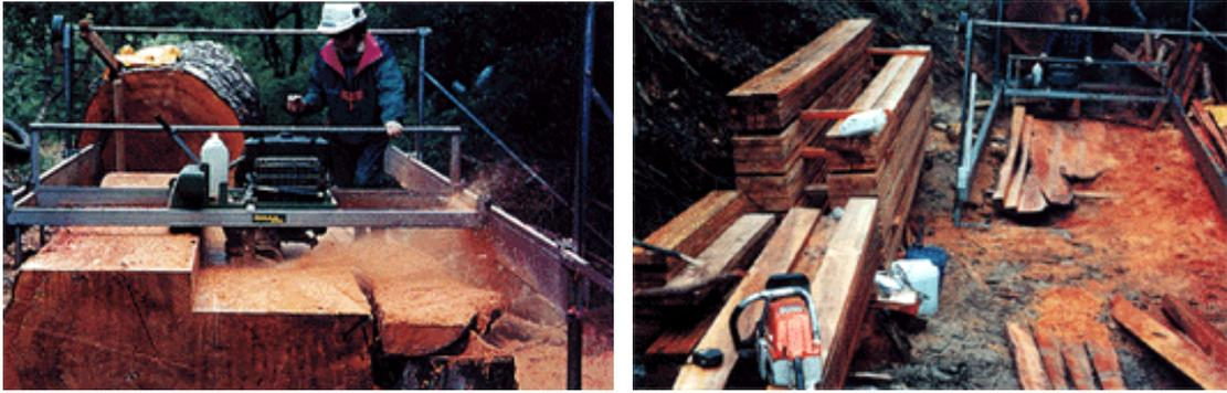
**Ilustração 1.** Aplicação da serraria portátil na floresta. Ergometria para o operador e aumento da produtividade. Fonte: [www.lucasmill.com.br](http://www.lucasmill.com.br).
