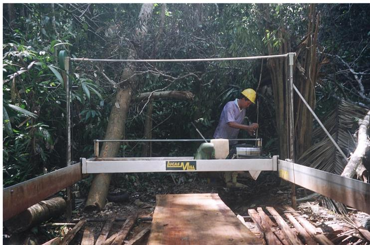
**Ilustração 9.** Processamento no campo com serraria portátil.
