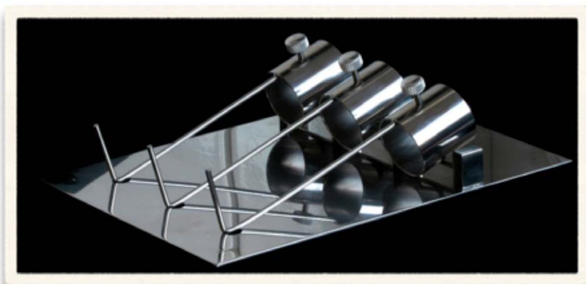
Figura 3 - Dispositivo de escovação simulada utilizado neste estudo.
