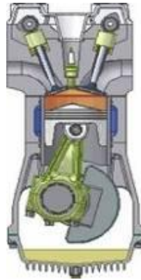
Figura A6.06 – Ciclos do motor 4 tempos
