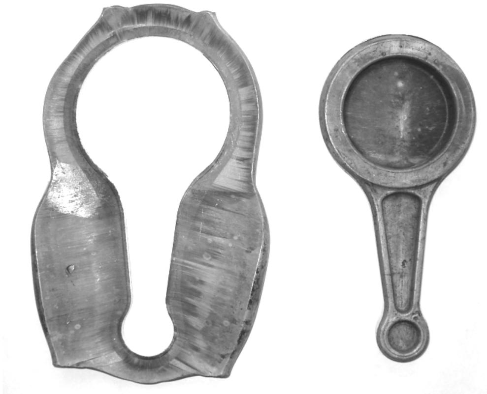
Figura 7.8: Rebarba retirada da peça e peça final
