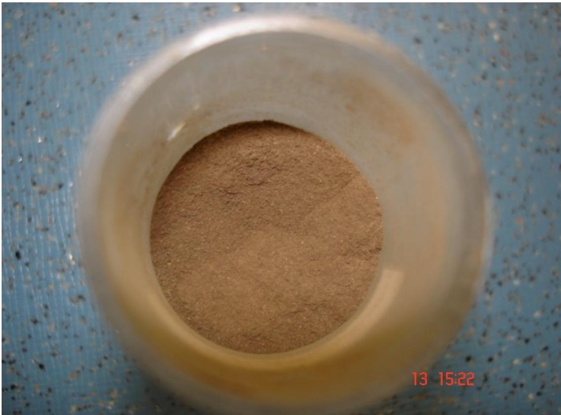
Figura 7.3 - Amostra de Lodo de esgoto aeróbio pulverizado, preparado para os ensaios de pirólise.
