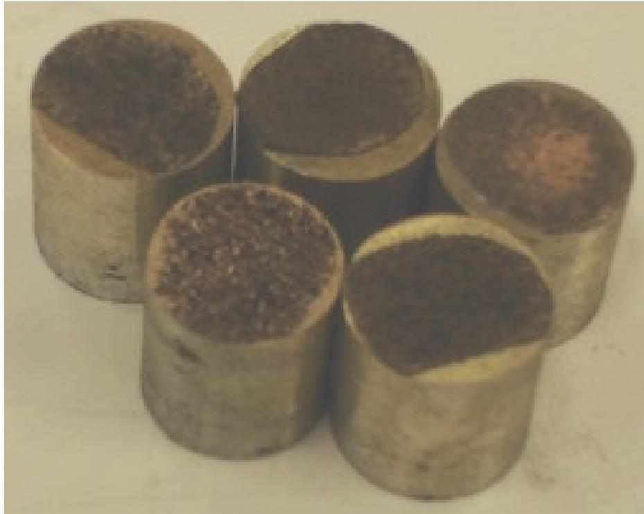
Figura 7.6 - Amostras do lodo e dos adsorventes preparadas para análise usando EDS-MEV.
