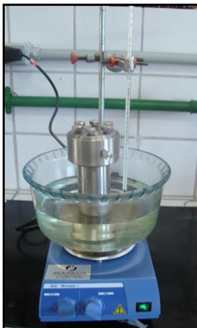
FIG 4.2 Sistema para reações a 120°C.
