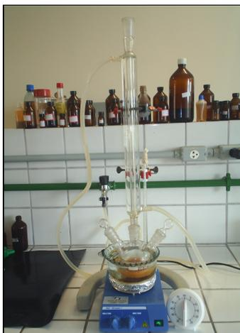
FIG 4.1 Sistema para reações a temperatura de refluxo.
