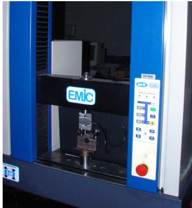
Fig. 9 - Máquina de ensaios universal EMIC DL 500.
