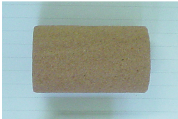
FIGURA 14 - Foto de uma amostra de rocha com a qual são construídos corpos de prova do Tipo 2.
