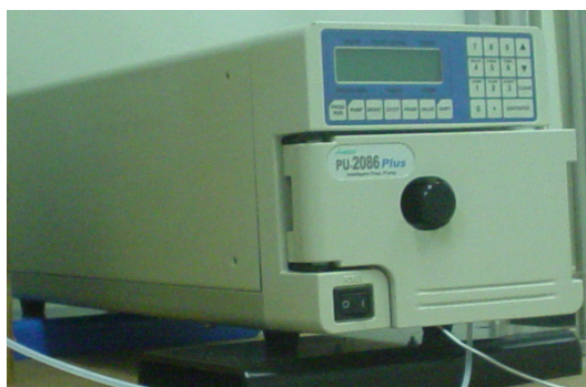
FIGURA 15 - Foto da bomba PU-2086 plus da Jasco.
