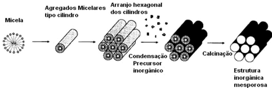
Figura II.2: Esquema da formação da estrutura inorgânica mesoporosa mediada por agente direcionador de estrutura. Figura adaptada de Raman *et al.*, 1996.
