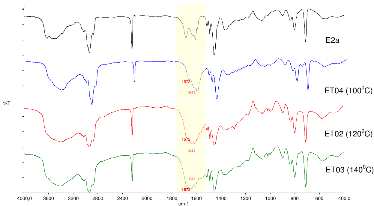
FIG. 3.36 Espectros de infravermelho dos copolímeros: E2a, ET04, ET02, ET03
