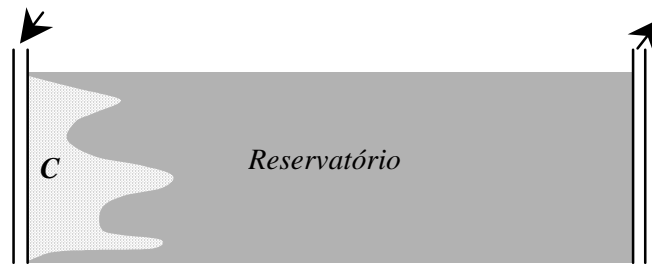
Figura 1 - Esquema mostrando a injeção de água com uma concentração "C" de partículas.
