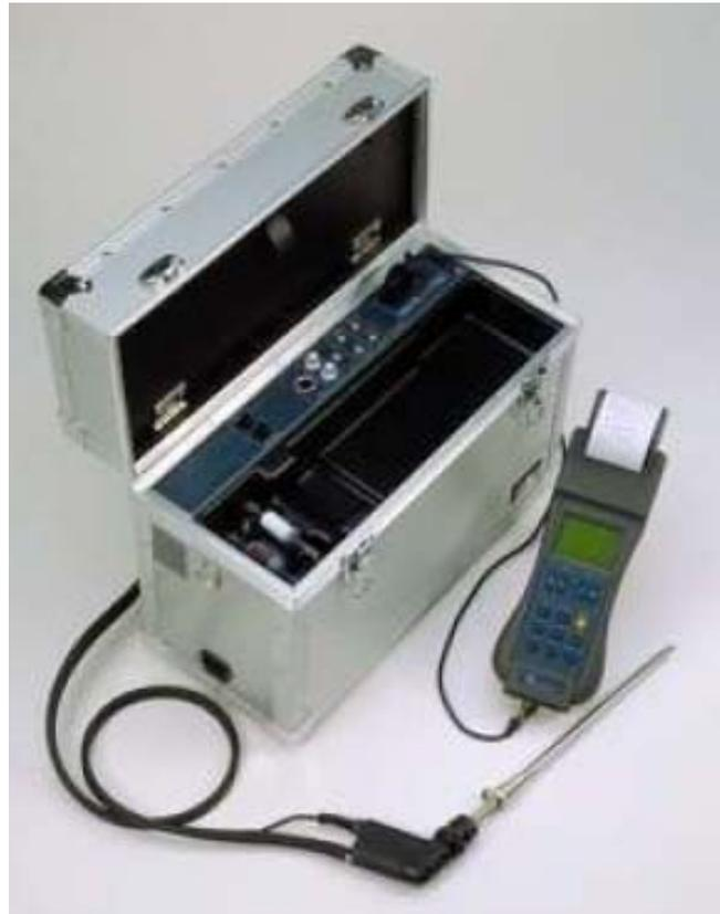
Figura 3.9 - Analisador de gases Ecoline 6000 da Eurotron. Fonte: [www.ecil.com.br](http://www.ecil.com.br). Acesso em: 03 jul. 2005.
