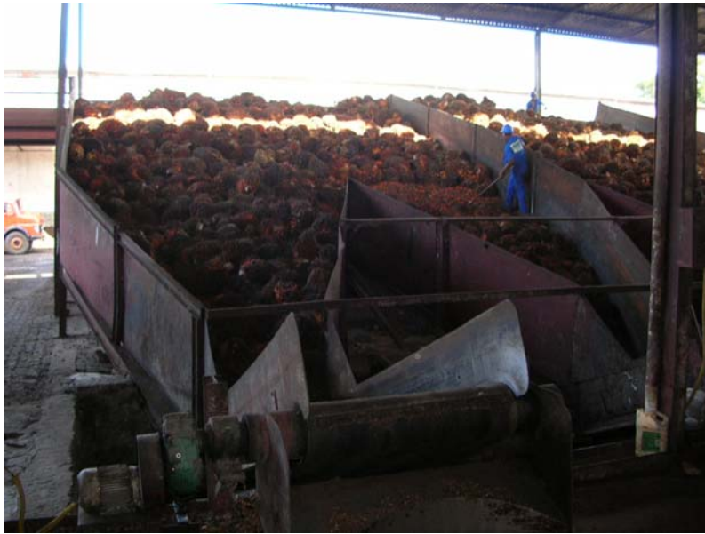
Figura 2.21: Rampa de Recebimento em usina de beneficiamento em Nazaré, na Bahia
