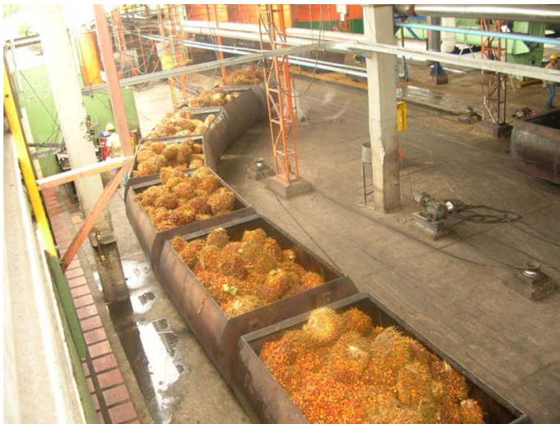
Figura 2.22: Sistema de “trolleys” em usina de beneficiamento, na Zona Central na Colômbia
