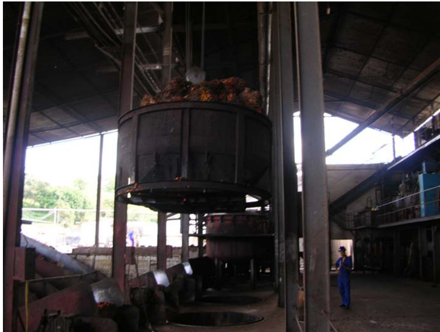
Figura 2.23: Envio do caldeirão ao esterilizador, em Nazaré na Bahia
