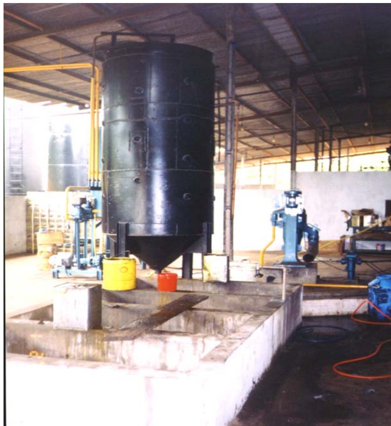
Figura 2.41: Decantador de óleo de palma em agroindústria.
