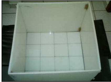
Figura 4: Fotografia da arena em polietileno opaco (60X60X60cm) utilizada em nossos experimentos, quadrados medindo 15cm de cada lado.
