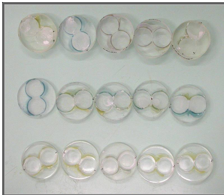
FIGURA 7 – Corpos-de-prova fixados em discos acrílicos para o processo de acabamento e polimento em politriz
