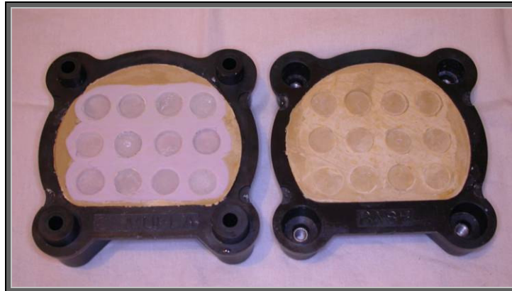
FIGURA 6 – Discos acrílicos incluídos em gesso pedra e silicone laboratorial, em mufla para microondas
