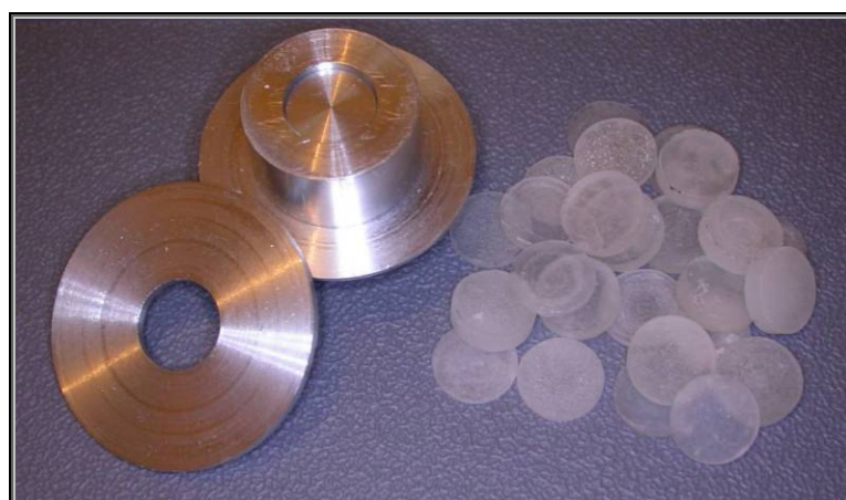
FIGURA 5 - Matriz metálica e discos acrílicos para obtenção dos moldes em mufla
