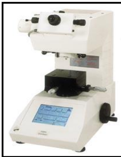
Figura 5 - Shimadzu Micro Hardness Tester HMV-2 (Fonte: Shimadzu Corporation)
