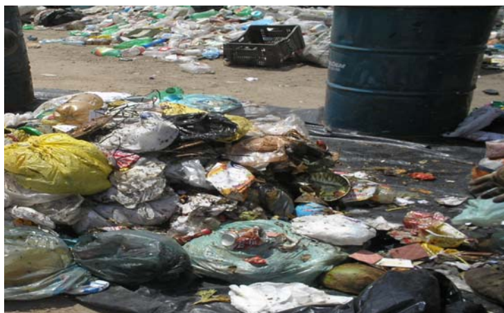
Figura 13 - Preparação das amostras dos resíduos domiciliares para o quarteamento.
