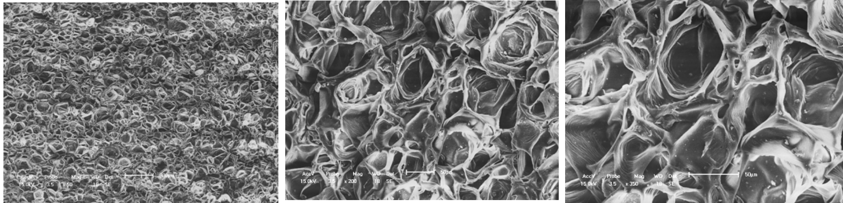
Figura 61. Espuma de EVA com 5 pcr de PCC, \phi de 5,9 \mu\text{m} , Barraleve. Ampliação de 50X, 200X e 350X.
