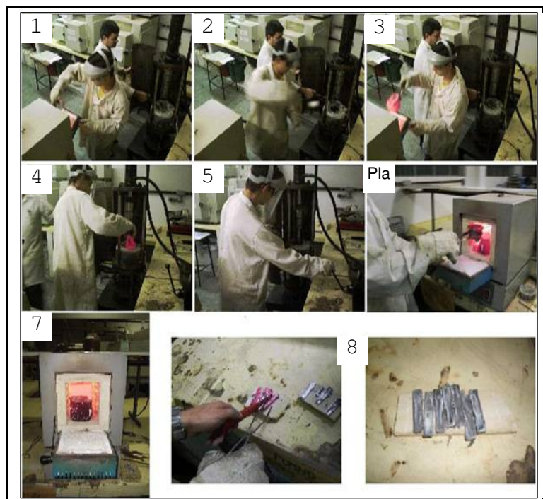
Figura A1 Etapas do processo “squeeze – casting”
