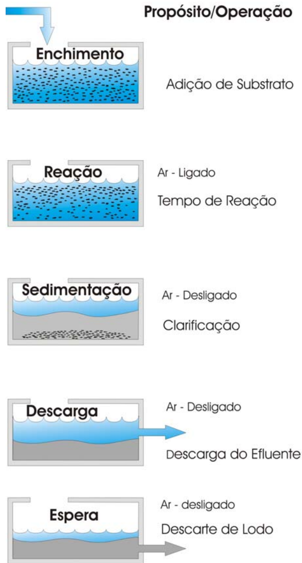
FIGURA 7 Diagrama esquemático do reator em batelada seqüencial (RBS) operando no processo de lodo ativado (METCALF & EDDY, 2003).
