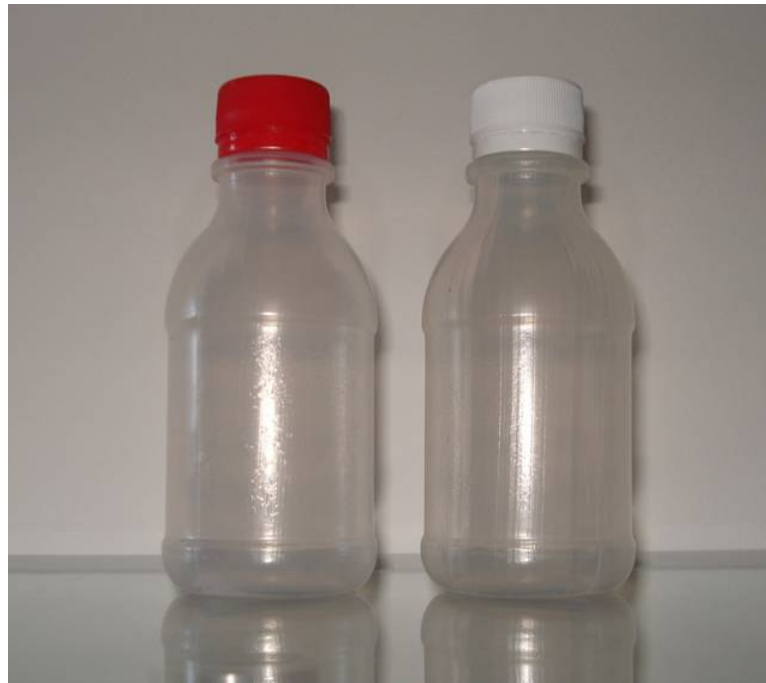
Figura 2 - Frascos de polietileno de 200mL utilizados para a coleta das amostras de água, Ceará, 2007.
