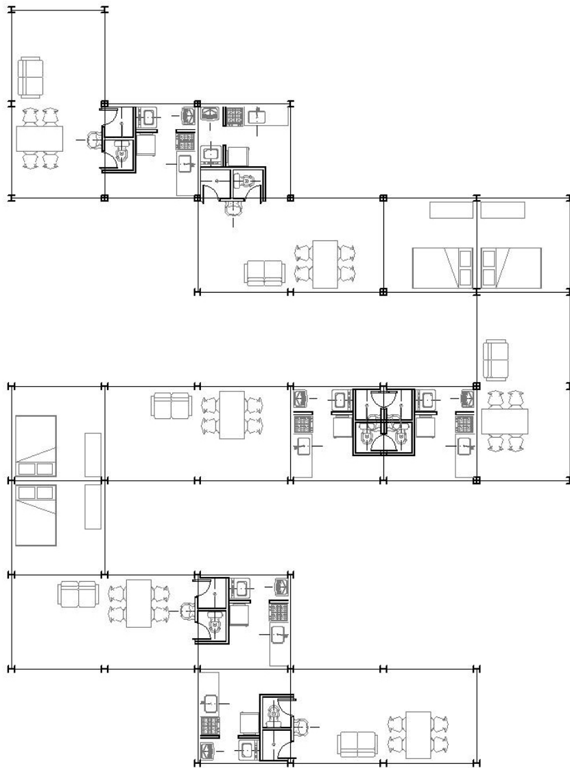
Figura 1.3 – Ambientes pensados a partir de módulos de três metros ( M=3\text{m} \times 3\text{m} \times 3\text{m} ) e possíveis associações.
