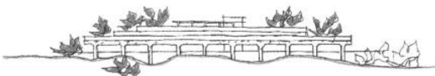
Figura 4.8 – Secretarias do Centro Administrativo da Bahia – Salvador, BA, Brasil, 1973. Arquiteto: João Filgueiras Lima, Lelé. Croqui da implantação, elevação esquemática. Situação desejada: minimização do número de pilares e conseqüente liberação do pavimento térreo.
