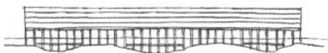
Figura 4.7 – Secretarias do Centro Administrativo da Bahia – Salvador, BA, Brasil, 1973. Arquiteto: João Filgueiras Lima, Lelé. Croqui da implantação, elevação esquemática. Situação não desejada: excesso de pilares.
