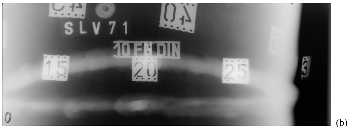
Figura 5.3 – (a) Radiografia panorâmica de um cordão de solda com reforço (imagem de 1298 \times 4880 pixels da coleção BAM-I); (b) Radiografia PD-VD de um cordão de solda incompleto (imagem de 1760 \times 4668 pixels da coleção BAM-I).
