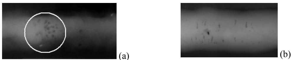
Figura 2.16 – Trechos de radiografias do IIW de soldas mostrando (a) poros arredondados agrupados e (b) poros tubulares espalhados.
