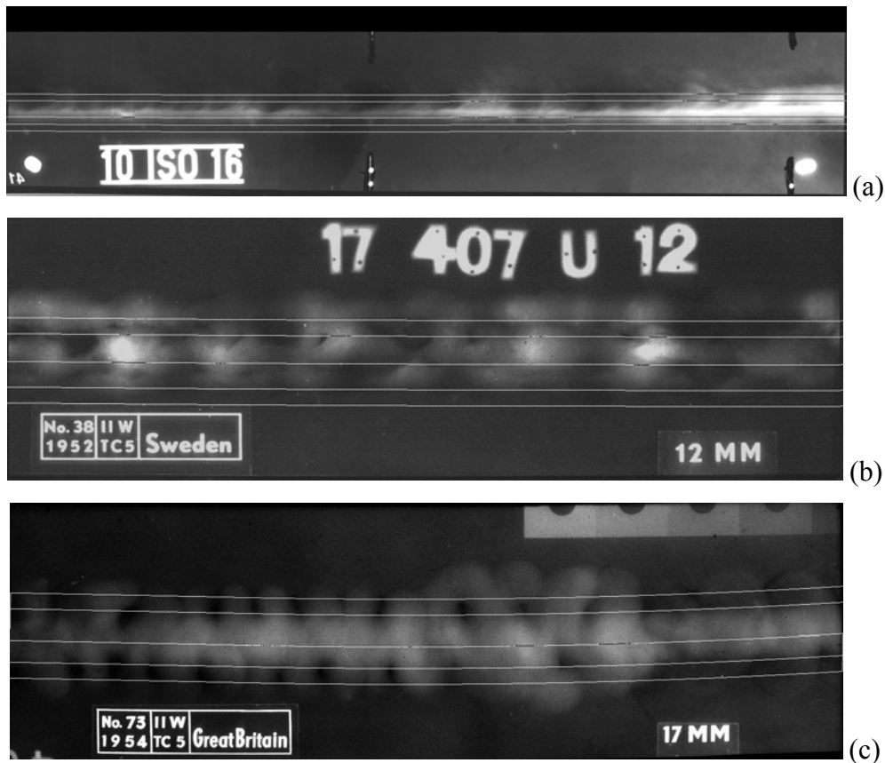
Figura 6.16 – Detecção do cordão de solda nas imagens (a) IIW-I 41 (b) IIW-I 38 (c) IIW-I 73
