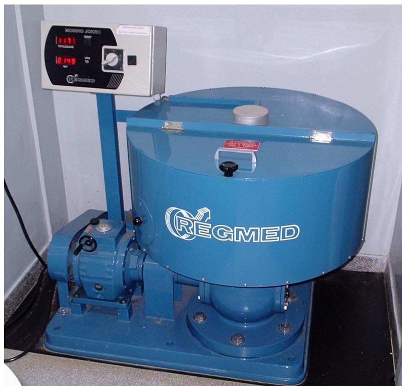
Figura 14 – Moinho tipo Jokro Mühle para refinamento de Polpas celulósicas.
