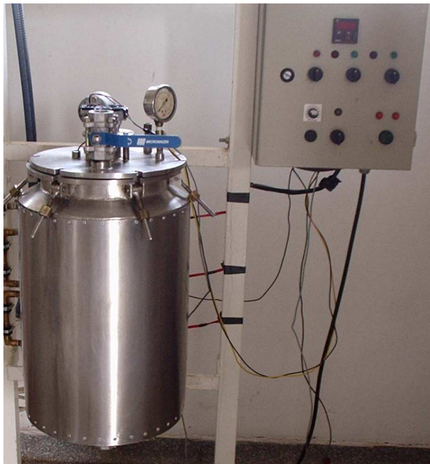
Figura 11 - Reator com agitador e controle de temperatura utilizado no processo de polpação.
