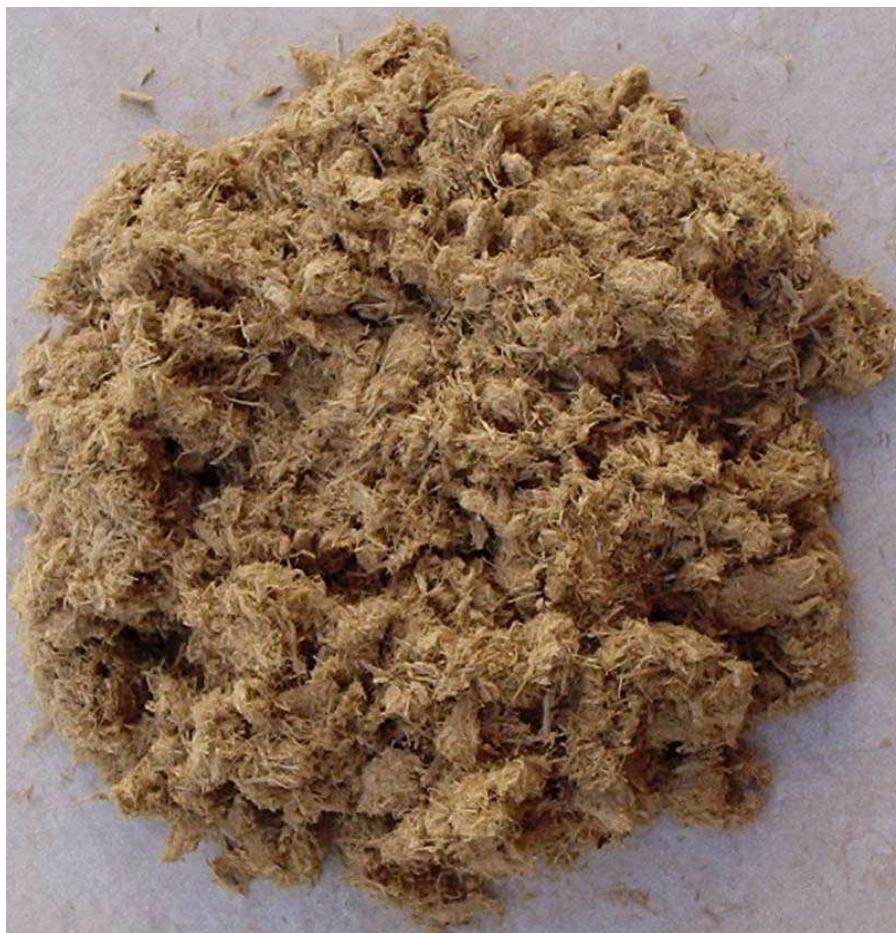
Figura 13 - Polpa celulósica seca em estufa após tratamento deslignificante e desintegração.
