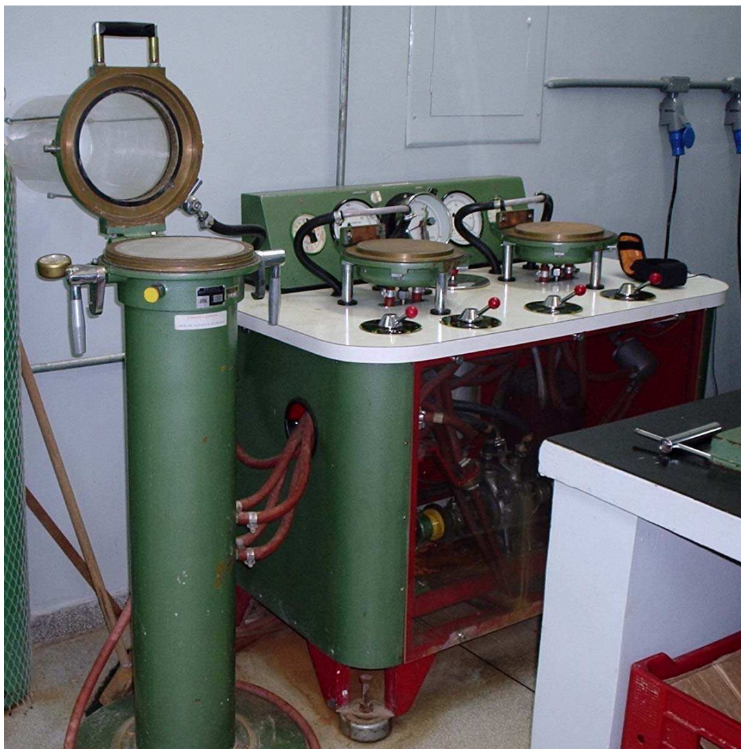
Figura 19 - Equipamento Regmed formador de folhas de papel com 20 cm de diâmetro.
