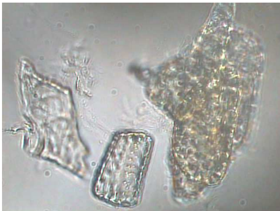
Figura 24 – Micrografia de aglomerados de fibras da celulose - 40 ampliações
