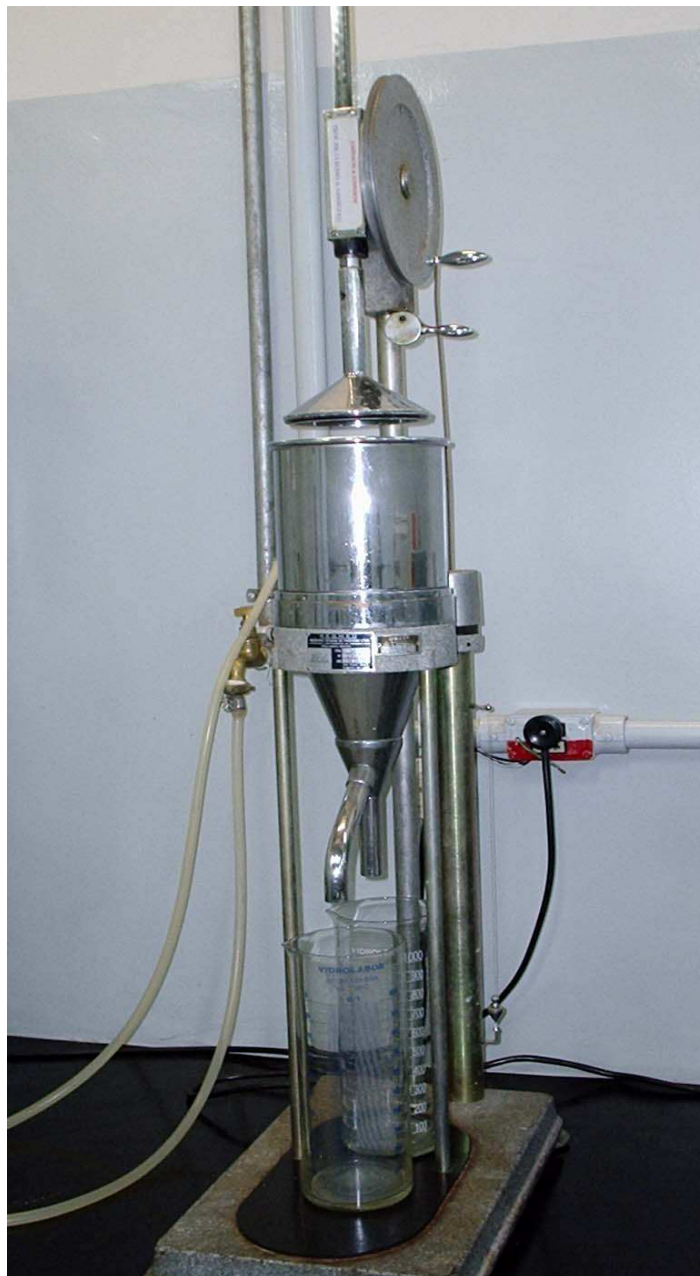
Figura 18 – Aparelho Schopper Riegler para medir grau de refino.
