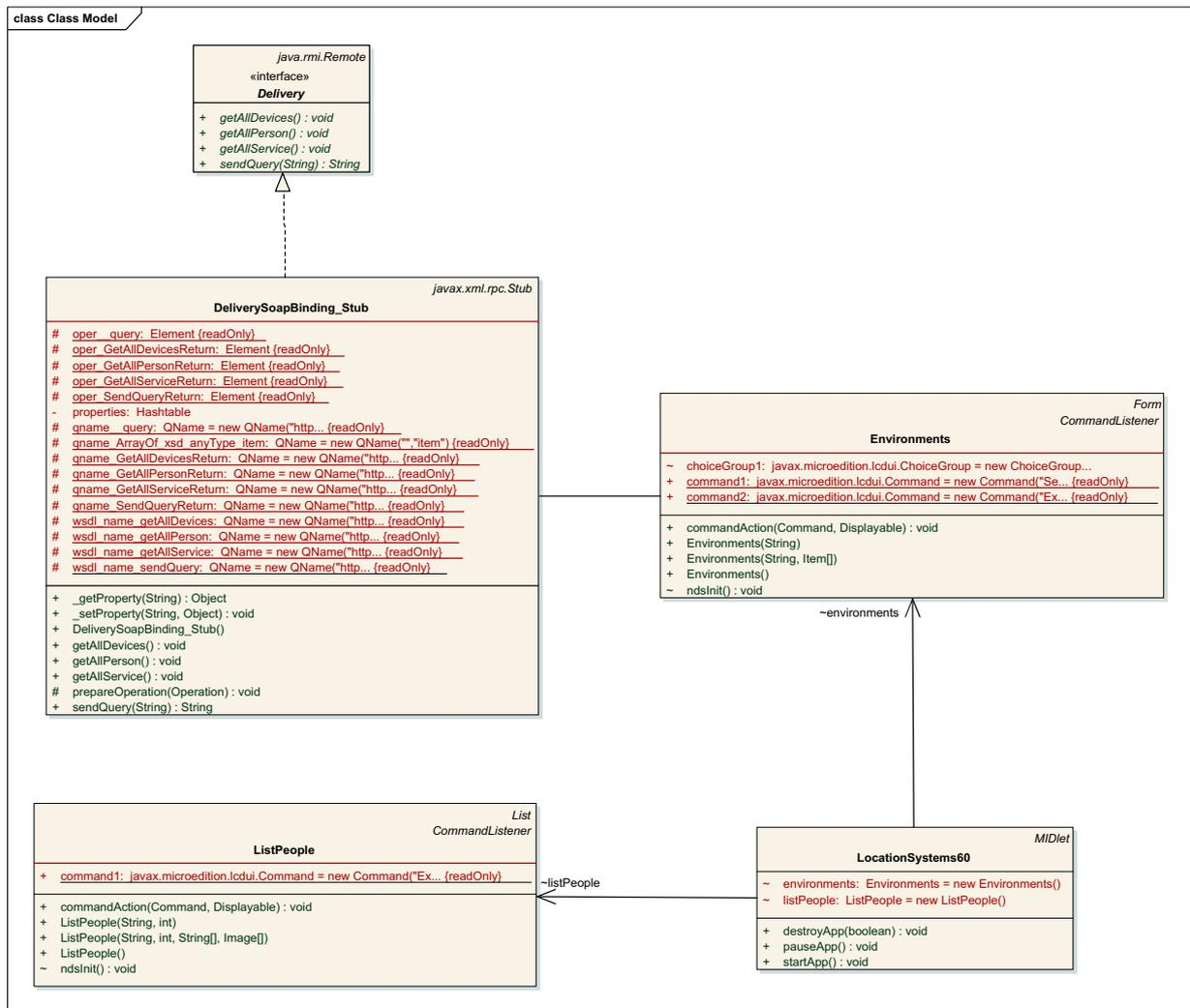
Figura 5.3: Diagrama de Classes do Sistema de Localização
