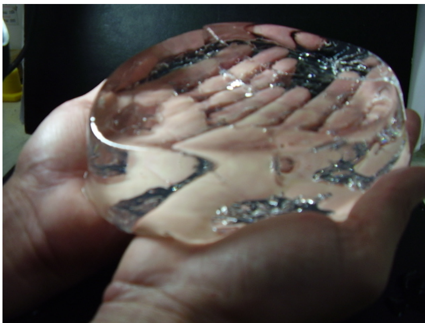
Figura 4.8 - Fotografia do hidrogel de GAMA-co-AAC-co-AAm (1,5-0,5-0,5) após 24 horas de imersão em água. (Guilherme e colaboradores, Patente - Brasil, 220504365123).
