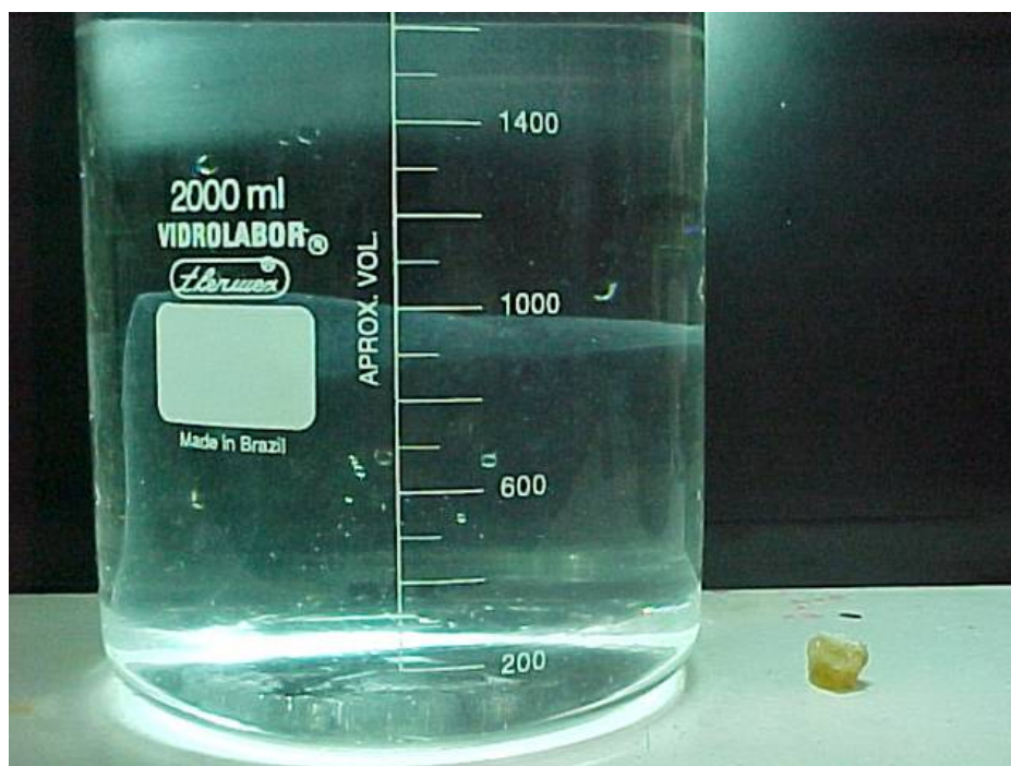
Figura 2.15 - Fotografia do hidrogel GCMA-co-AAm (0,1/0,01/3) seco, à esquerda e intumescido cerca de 1000 vezes, à direita.
