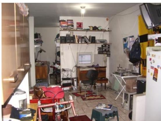
**Figura 72:** Excesso de equipamentos e fios podendo causar sobrecarga nas instalações elétricas (insuficientes)
