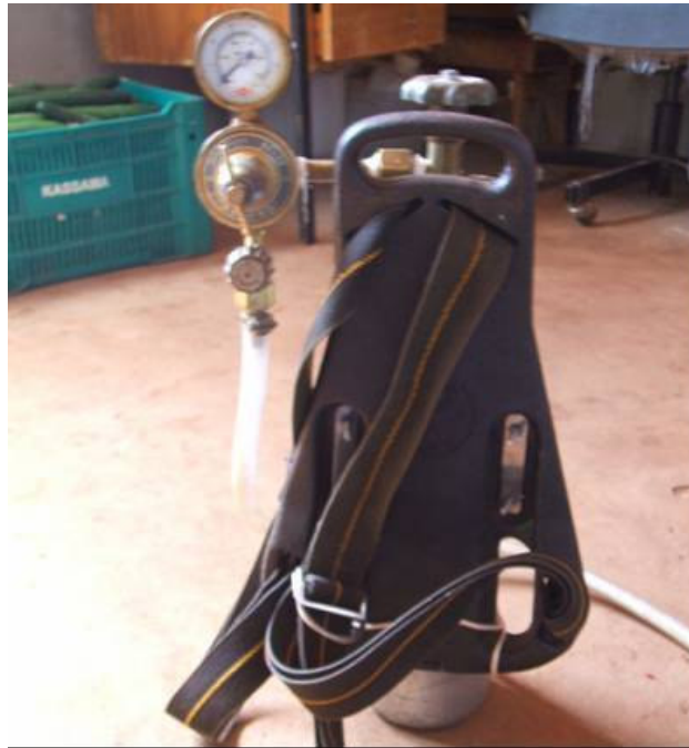
Figura 2 – Pulverizador tipo “costal” de pressão constante de CO 2 . UNESP/FCA, Botucatu, SP, 2007.
