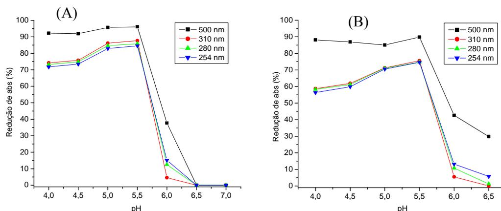
Figura 11. Redução porcentual de absorvância em diferentes comprimentos de onda no efluente da coleta 1 em tratamento a diversos pHs, utilizando: (A)  $45,0 \text{ mg L}^{-1}$  de cloreto férrico e (B)  $50,0 \text{ mg L}^{-1}$  de sulfato férrico.
