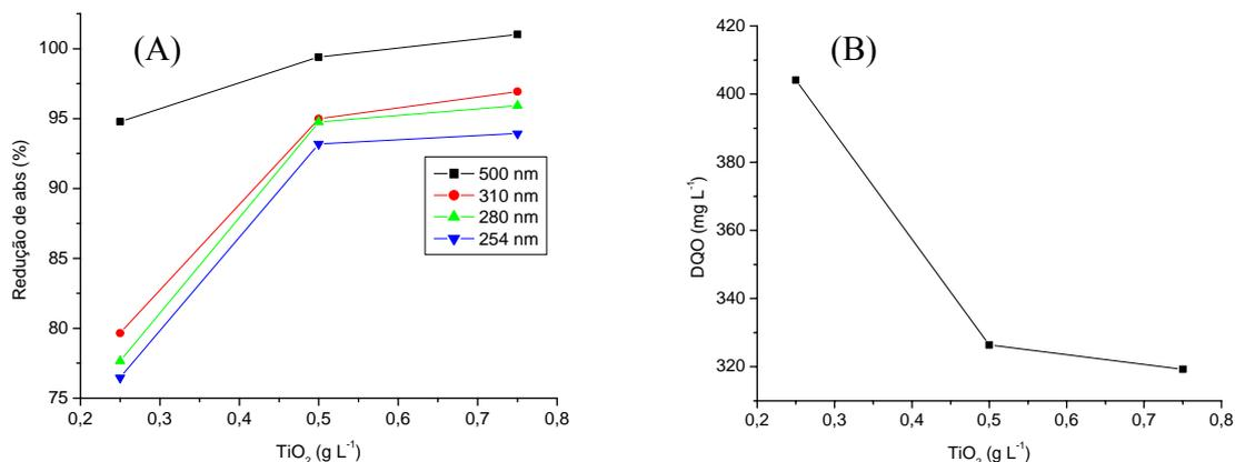
Figura 19. Otimização da concentração de TiO<sub>2</sub> na fotocatalise. (A) redução de absorvância em diferentes comprimentos de onda; (B) concentração de DQO. Efluente submetido ao tratamento combinado. Etapa 1: 80 mg L<sup>-1</sup> de FeCl<sub>3</sub> e pH= 6,0. Etapa 2: irradiação por 360 min e pH= 3,0.
