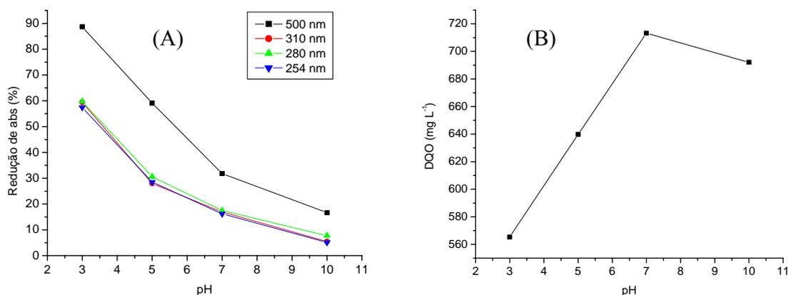
Figura 18. Estudo do pH na fotocatalise com o TiO<sub>2</sub>. (A) redução de absorvância em diferentes comprimentos de onda; (B) concentração de DQO. Amostras de efluente *in natura* (diluído 1:1, v/v) após 360 min de irradiação com 0,50 g L<sup>-1</sup> de TiO<sub>2</sub>.
