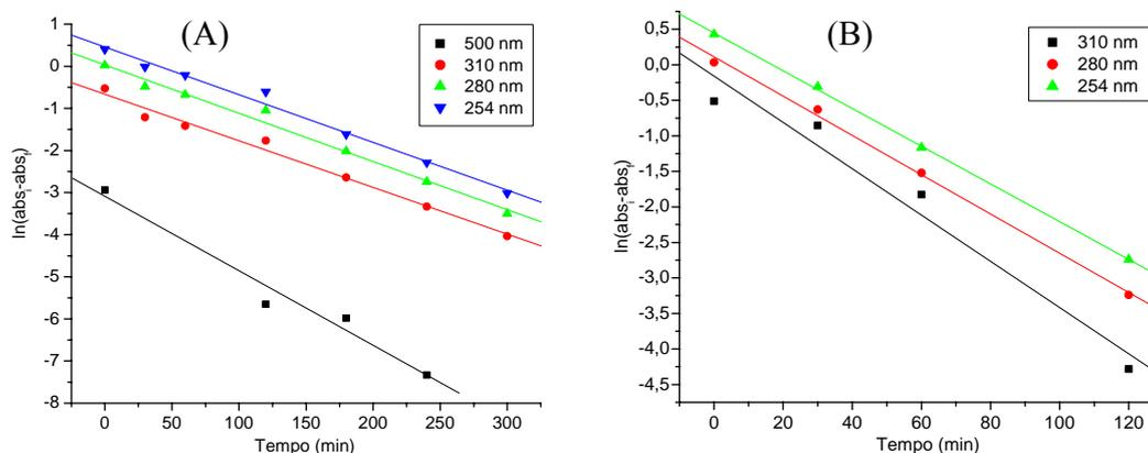
Figura 23. Parâmetros cinéticos do decaimento de primeira-ordem obtidos na amostra de sobrenadante do coagulado ( $80 \text{ mg L}^{-1}$  de  $\text{FeCl}_3$  e  $\text{pH}= 6,0$ ) para a fotocatalise realizada a  $\text{pH}= 3,0$  na presença de: (A)  $0,50 \text{ g L}^{-1}$  de  $\text{TiO}_2$  e (B)  $0,50 \text{ g L}^{-1}$  de  $\text{TiO}_2$  +  $10 \text{ mmol L}^{-1}$  de  $\text{H}_2\text{O}_2$ .
