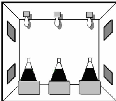
Figura 9. Ilustração do foto-reator.
