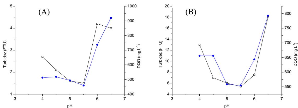
Figura 12. ( $\square$ ) valores de turbidez e ( $\bullet$ ) concentração de DQO no efluente em função do pH no tratamento por coagulação, utilizando (A)  $45,0 \text{ mg L}^{-1}$  de cloreto férrico e (B)  $50,0 \text{ mg L}^{-1}$  de sulfato férrico. Coleta 1.
