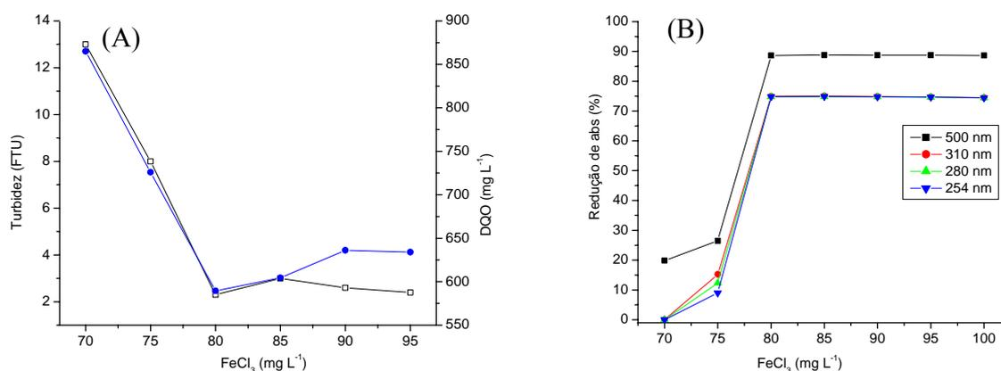
Figura 16. Estudo da influência da concentração do  $\text{FeCl}_3$  na coagulação dos poluentes da coleta 2: (A) (□) turbidez e (●) DQO. (B) redução de absorvância porcentual em diferentes comprimentos de onda. Amostras analisadas após coagulação em  $\text{pH} = 6,0$ .
