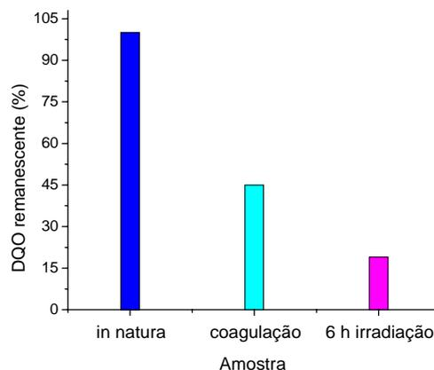
Figura 26. DQO para o efluente *in natura* (■); após a coagulação/floculação (com  $80 \text{ mg L}^{-1}$  de cloreto férrico e  $\text{pH} = 6,0$ ) (■); e após o tratamento combinado (6 h de fotocatalise em  $0,50 \text{ g L}^{-1}$  de  $\text{TiO}_2$  +  $10 \text{ mmol L}^{-1}$  de  $\text{H}_2\text{O}_2$  e  $\text{pH} = 3,0$ ) (■).
