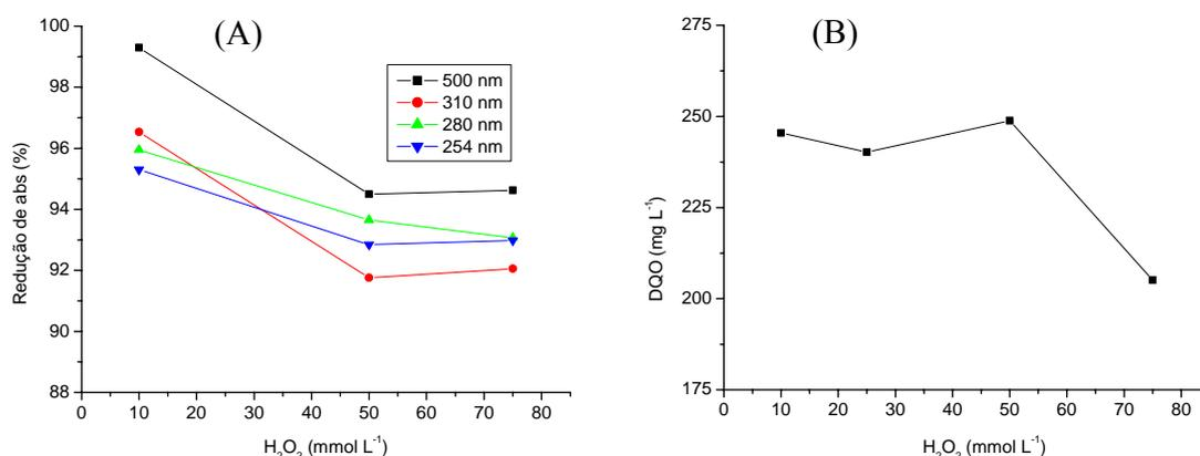
Figura 20. Otimização da concentração de  $\text{H}_2\text{O}_2$  na fotodegradação. (A) redução de absorvância em diferentes comprimentos de onda; (B) concentração de DQO. Efluente do tratamento combinado. Etapa 1:  $80 \text{ mg L}^{-1}$  de  $\text{FeCl}_3$  e  $\text{pH}= 6,0$ . Etapa 2: irradiações por 360 min,  $0,50 \text{ g L}^{-1}$  de  $\text{TiO}_2$  e  $\text{pH}= 3,0$ .
