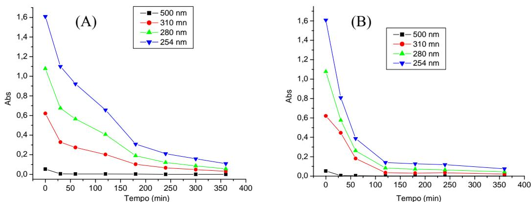
Figura 22. Cinética da fotodegradação realizada em amostras da Etapa 1 (coagulação com  $\text{FeCl}_3 = 80 \text{ mg L}^{-1}$  e  $\text{pH} = 6,0$ ) através da irradiação em  $\text{pH} = 3,0$  utilizando-se: (A)  $0,50 \text{ g L}^{-1}$  de  $\text{TiO}_2$  e (B)  $0,50 \text{ g L}^{-1}$  de  $\text{TiO}_2 + 10 \text{ mmol L}^{-1}$  de  $\text{H}_2\text{O}_2$ .
