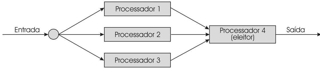
Figura 2.4: Um sistema tolerante a falhas.
