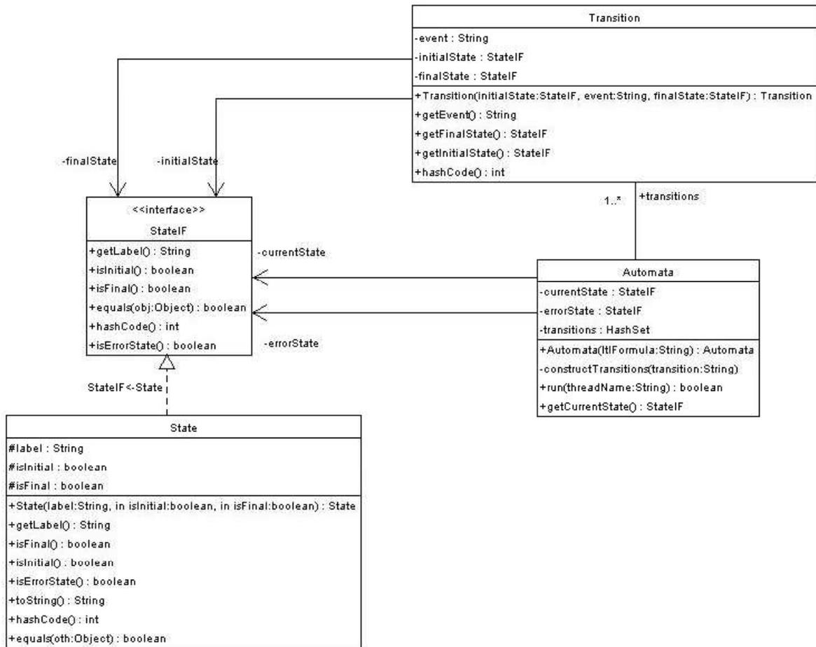
Figura 4.6: Diagrama de classe do conversor do *DesignMonitor* para máquinas de estados.
