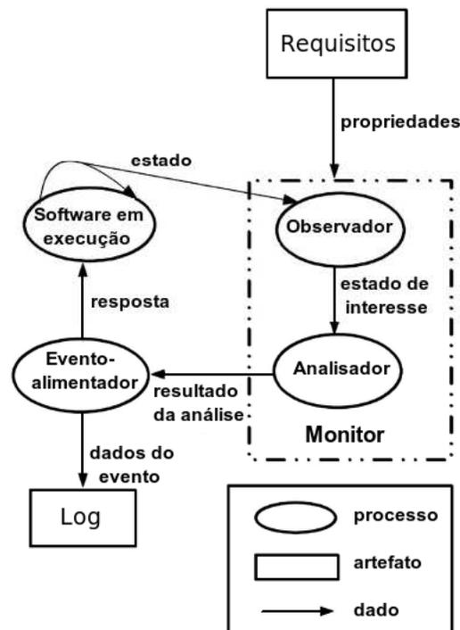
Figura 2.2: Visão de alto-nível de um Monitor em tempo de execução.
