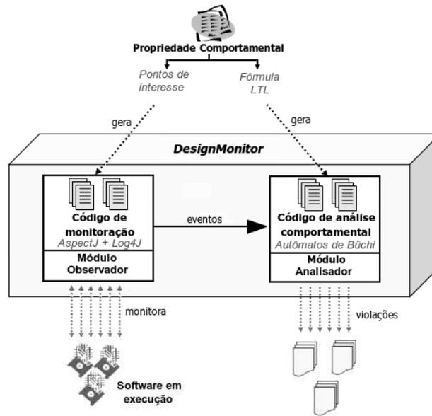
Figura 7.1: Visão geral da ferramenta *DesignMonitor*.
