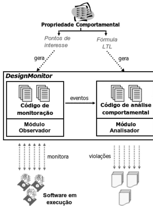
Figura 3.4: Visão geral do processo para instrumentação e análise comportamental em tempo de execução.
