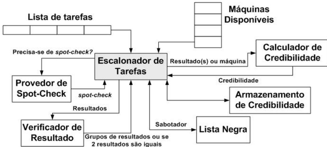
Figura 3.1: Interações entre os componentes do serviço de escalonamento.
