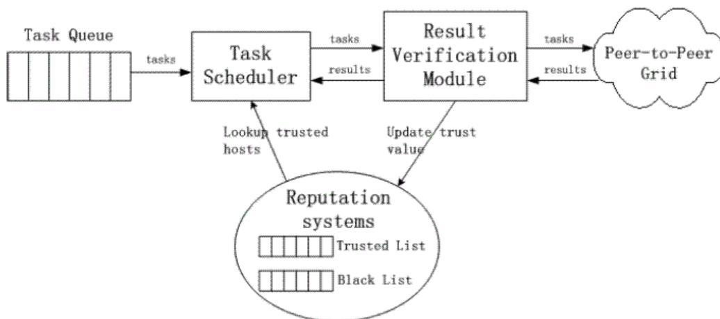
Figura 5.2: Modelo de escalonamento baseado em confiança.
