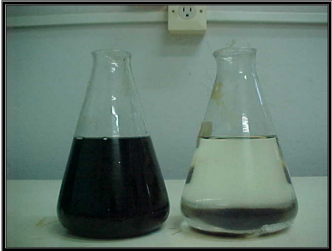
Figura 17. Eficiência do processo de fotodegradação para o Ef 3 após a otimização das condições ( \text{H}_2\text{O}_2 1,0 \times 10^{-2} mol L -1 , Fe (II) 1,0 mg L -1 em pH 3 após 6h de fotodegradação)
