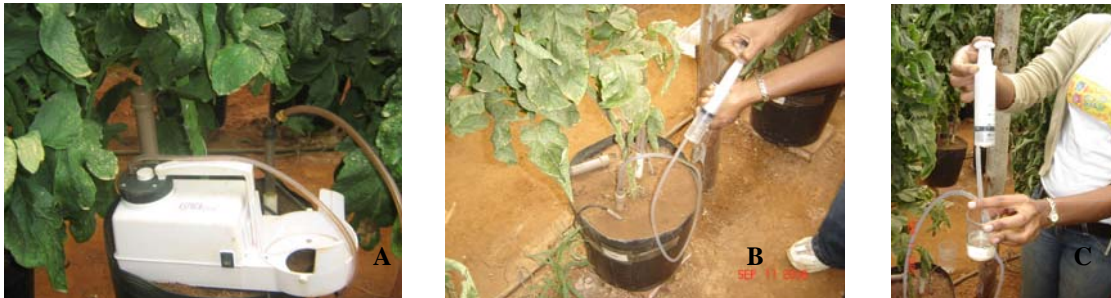
Figura 7 - Realização de vácuo (A) e coleta da solução do solo por meio de extratores com o uso de seringa (B e C)
