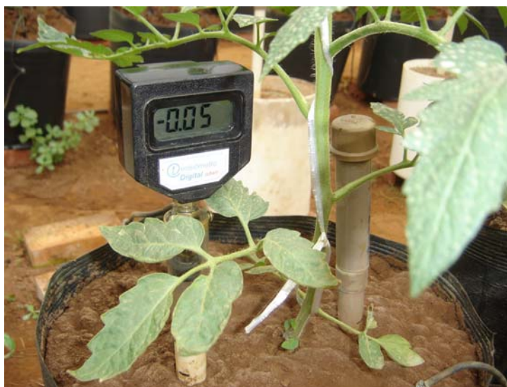
Figura 6 - Leitura da tensão da água do solo por meio de tensímetro eletrônico de punção
