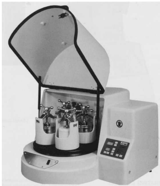
Fig. 2.7 Modelo Pulverisette P-5, da Frischt, com quatro estações de moagem.
