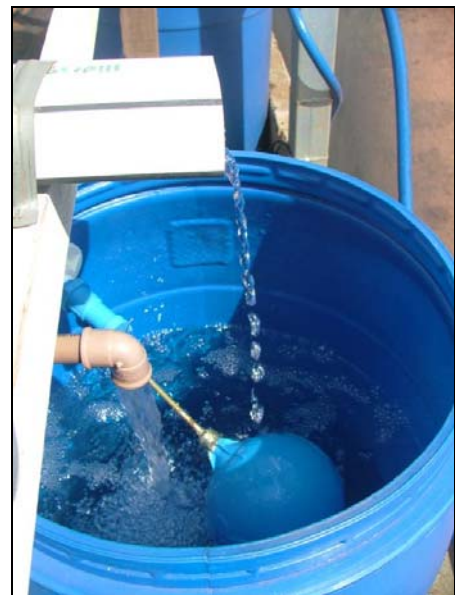
Figura 20 - Solução nutritiva sendo oxigenada e direcionada mediante joelho de 90°
