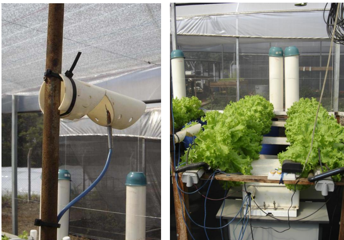
Figura 13 - Termopar instalado à 2 m de altura e datalogger usado para aquisição dos dados
