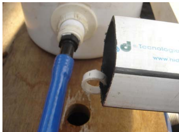
Figura 22 - Detalhe do anel de PVC utilizado para evitar o vazamento de solução nutritiva
