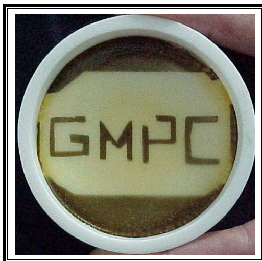
Figura 4.26 – Resultado da exposição do filme de PVC/Py/FeCp 2 , a irradiação UV (254 nm), durante 60 mim.
