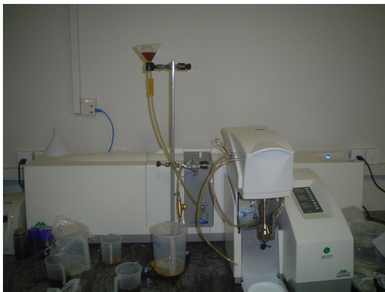
Figura 26: Equipamento para determinação da DTG - modelo MASTERSIZER 2000 da MALVERN
