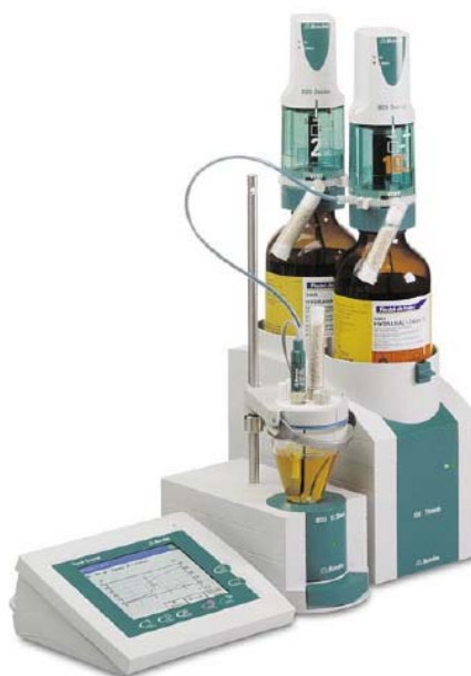
Figura 23: Sistema de análise do teor de água baseado no método de titulação potenciométrica empregando reagente de Karl Fisher
