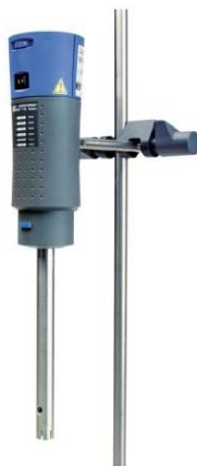
Figura 24: Geração de emulsão – homogeneizador ULTRA-TURRAX
