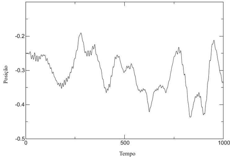
Figura 3.1: A simulação foi feita com  $10^7$  rotores, com energia inicial de 0,60 e condição inicial *water bag* homogêneo. Observe que as partículas realmente permanecem durante certo tempo em ângulos fixos e depois descrevem longos saltos em direção a outras configurações.
