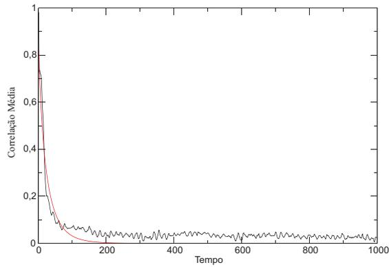
Figura 4.24: Correlação de velocidades para 100 simulações realizadas num tempo de  $10^3$  com  $10^3$  rotores e passo de tempo de  $\Delta t = 0,5$  e condição inicial *water bag* coerente com energia inicial de 0,69. O ajuste da relação 4.23 resulta em  $A = 0,89$ ,  $B = -9,2 \times 10^{-3}$  e  $\kappa = 0,781293$ .
