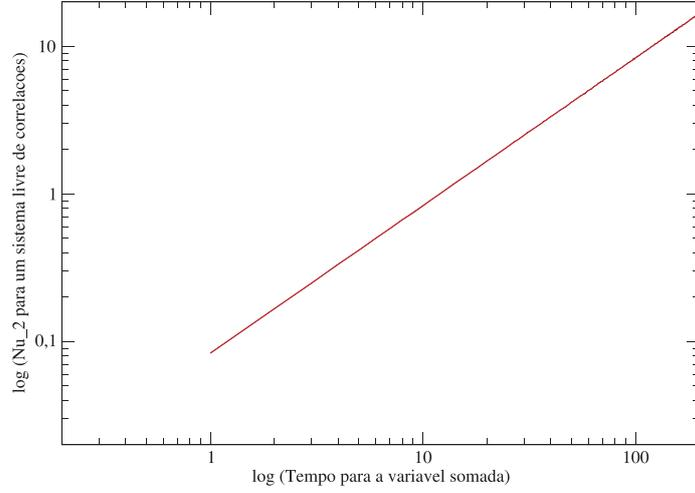
Figura 2.2: Desvio quadrático médio  $\nu_2$  em função do número de passos aleatórios não-correlacionados (tempo). A curva de ajuste  $\nu_2 = Ct^\mu$  apresenta  $C = 0,083$  e  $\nu_2 = 1,00$ .
