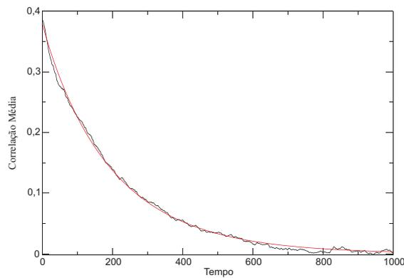
Figura 4.25: Correlação de velocidades para 100 simulações realizadas num tempo de  $10^6$  com  $10^4$  rotores, com passo de tempo de  $\Delta t = 0,5$  e condição inicial *water bag* homogêneo com energia inicial de 0,69. O ajuste da relação 4.23 resulta em  $A = 0,38$ ,  $B = -6,4 \times 10^{-4}$  e  $\kappa = 0,956729$ .
