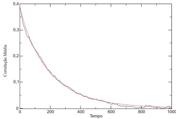
Figura 4.23: Correlação de velocidades para 100 simulações realizadas num tempo de  $10^3$  com  $10^3$  rotores e passo de tempo de  $\Delta t = 0,5$  e condição inicial *water bag* homogêneo com energia inicial de 0,69. O ajuste da relação 4.23 resulta em  $A = 0,39$ ,  $B = -7,8 \times 10^{-4}$  e  $\kappa = 0,925261$ .
