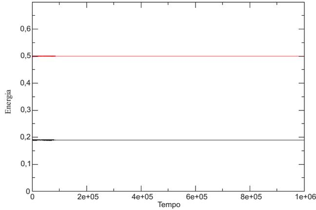
Figura 4.10: Gráfico das energias cinética (em preto) e potencial (em vermelho) para um sistema com  $10^6$  rotores ao longo do tempo e condição inicial *water bag* coerente com energia inicial de 0,69. Apesar de o estado inicial não ser homogêneo, o sistema rapidamente evolui, por relaxação violenta, para um estado homogêneo, a ponto do transiente inicial não ser visível no gráfico.
