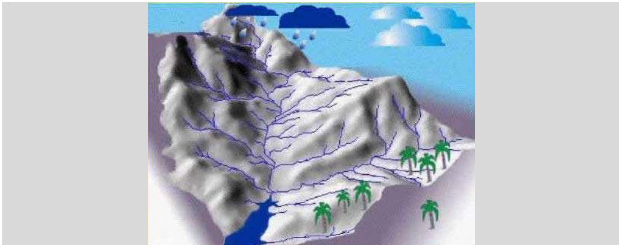
FIGURA 4: REPRESENTAÇÃO ESQUEMÁTICA DOS FLUXOS DAS ENCOSTAS PARA OS FUNDOS DE VALE E EM SUPERFÍCIE, POR MEIO DE CANAIS DE DRENAGEM Fonte: UNICAMP (2004)
