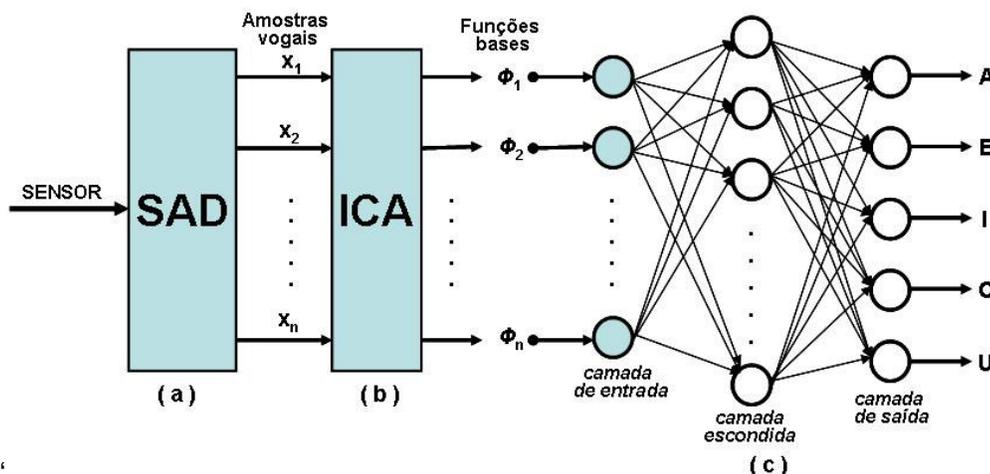
Figura 6: Sistema de reconhecimento da fala subvocal proposto: (a) - Fase de Aquisição de Dados. (b) - Fase de Aprendizagem dos Dados (c) - Fase de Classificação dos Dados
