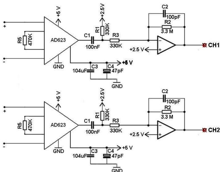
Figura 7: Circuito de Amplificação e Filtragem (Canal 1 (CH1), Canal 2(CH2)).
