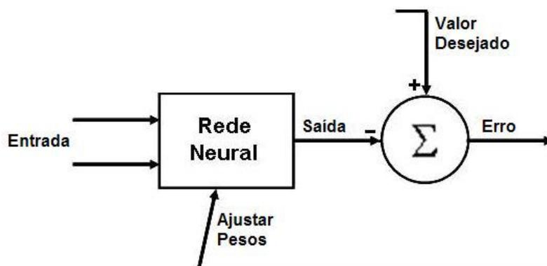
Figura 9: Esquema ilustrativo do processo de aprendizagem numa RNA
