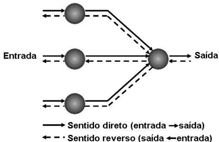
Figura 5: Ilustração das direções de dois fluxos básicos de um sinal em uma rede neural MLP:
