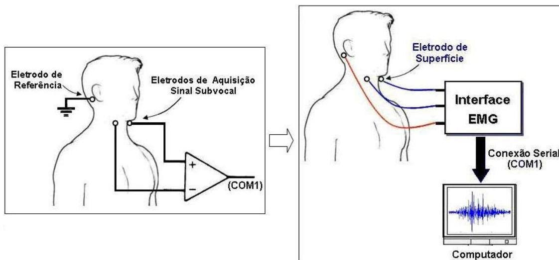
Figura 10: Diagrama do Sistema Subvocal (Posicionamento dos eletrodos e gravação)
