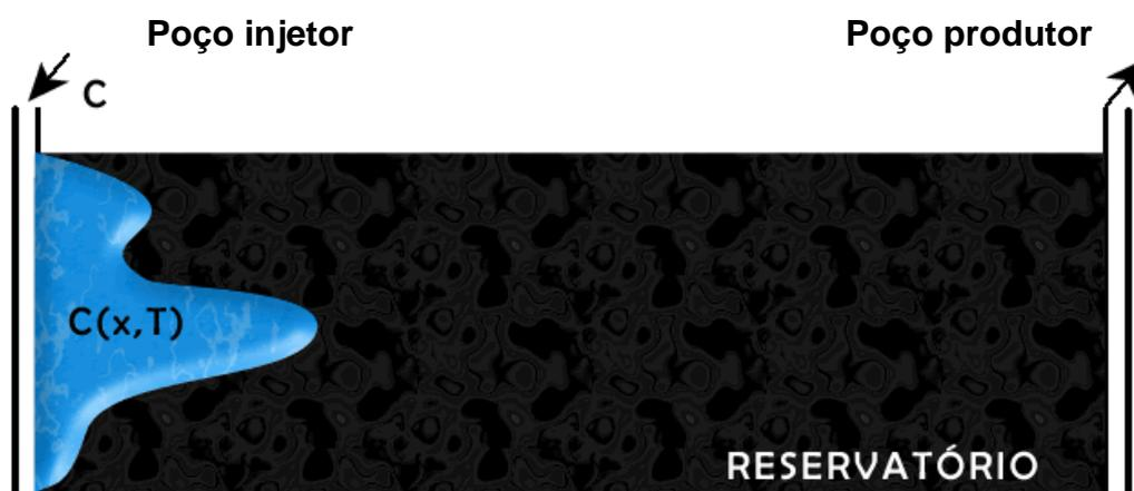
**Figura 1-1 - Esquema mostrando a injeção de água com uma concentração “C” de partículas.**
