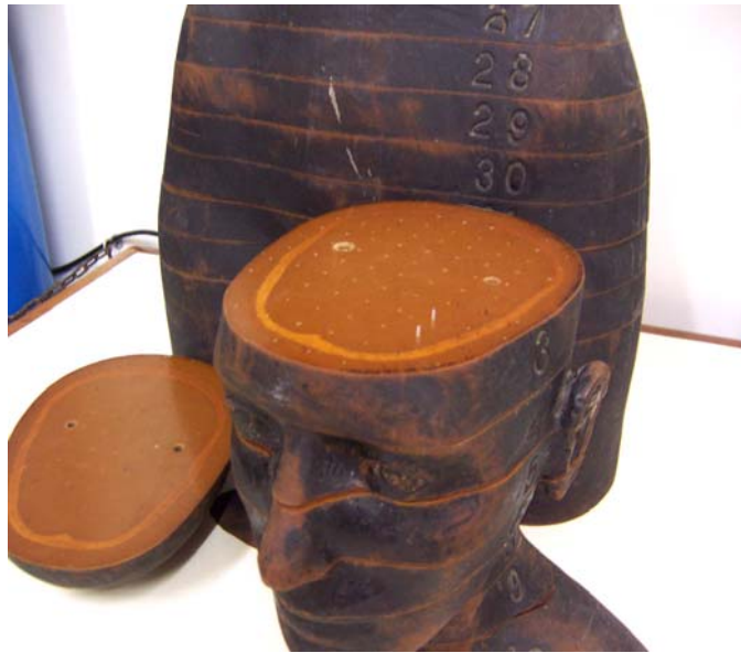
Figura 10 - Simulador antropomórfico seccionado com dosímetros termoluminescente
