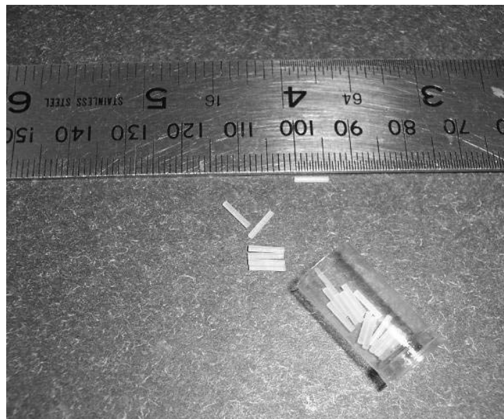
Figura 11 – Dosímetros termoluminescentes para medidas de dose
