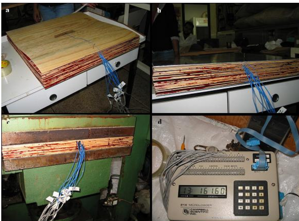
Figura 2 - Instalação dos termopares no painel. a) e b) instalação no interior das lâminas antes da entrada à prensa; c) prensagem do painel e d) vista geral do Micrologger.
