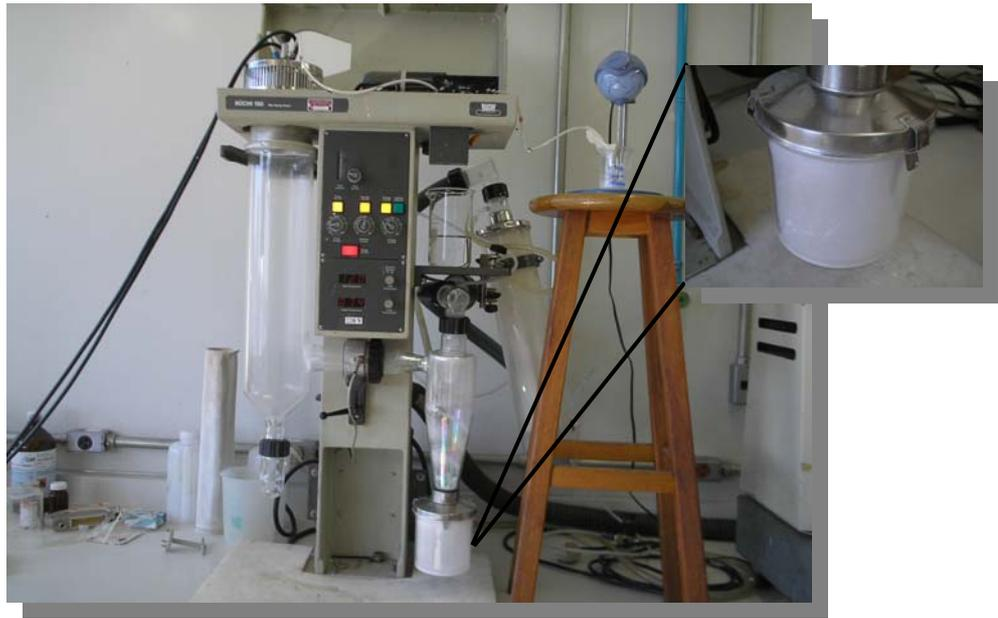
**Figura 2-5** Mini "spray-dryer" utilizado na encapsulação de Cetoprofeno no Poli(NVCL-co-AA)
