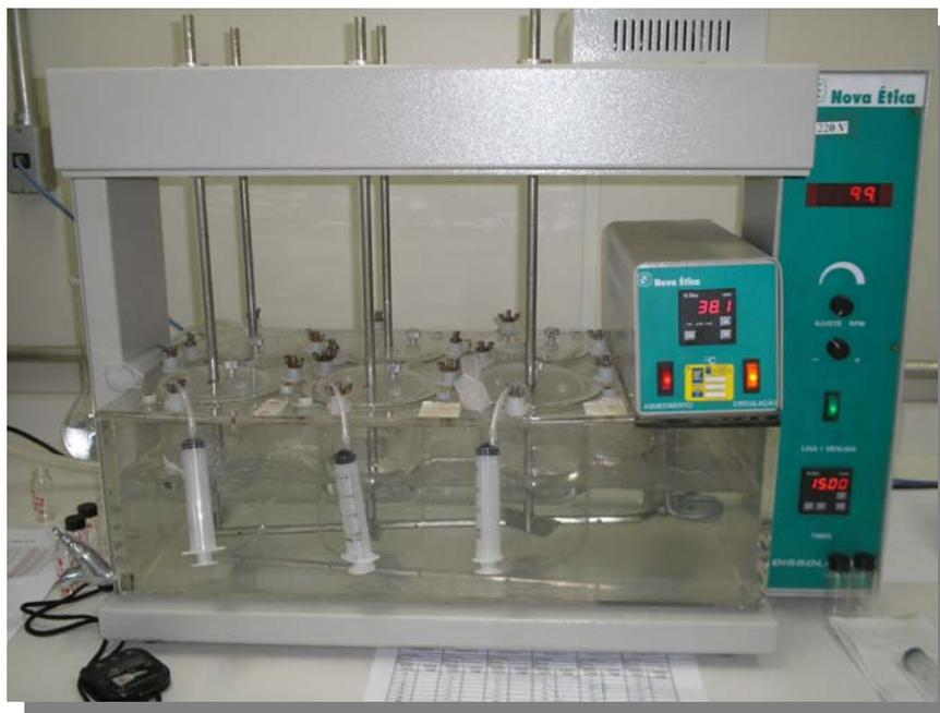
**Figura 2-7** Banho utilizado nos ensaios de liberação de Cetoprofeno do Poli(NVCL-co-AA)
