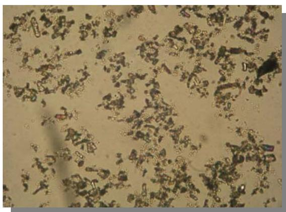
**Figura 3-9** Imagem obtida por microscopia ótica, com ampliação de 40X do produto seco da amostra com composição polímero/droga 1:1.
