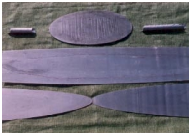
Figura 2.5 – Lâminas e tubos extrudados do compósito de matriz metálica da liga de alumínio 2014 reforçada com “whisker” de carbeto de silício [10].
