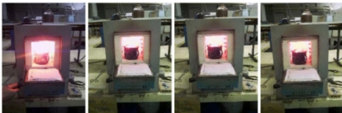
Figura 4.16 – Momentos da reação de aluminotermia para matrizes contendo sílica.
