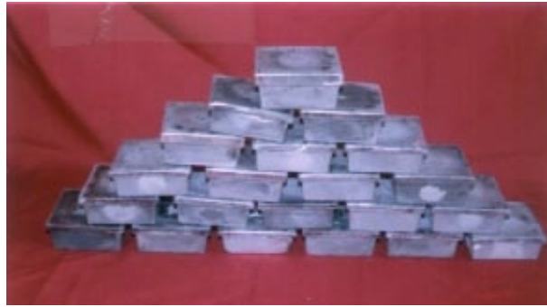
Figura 2.6 – Lingotes retangulares de compósitos de matriz metálica de alumínio produzidos pelo método de infiltração “Squeeze” de pré-formas de fibras cerâmicas [10].
