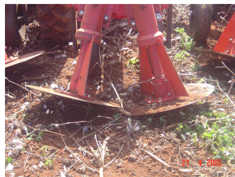
B – Detalhe discos Watanabe cortador
